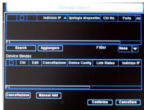
Utilizzare l'opzione del menù di configurazione mostrato sopra è possibile selezionare l'opzione "Add device" e quindi fare click sul pulsante "Search" per avviare una scansione dei dispositivi all'interno della propria rete LAN. Una volta trovata una telecamera fare doppio click su di essa per assegnarla ad uno dei canali da registrare. Facendo click sul pulsante "Conferma" le immagini provenienti dalle telecamere appariranno in corrispondenza dei canali configurati.
